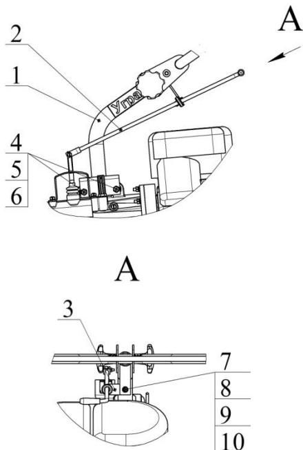
**Рисунок 10 – Установка рулевой колонки на мотоблоке «Угра».**
