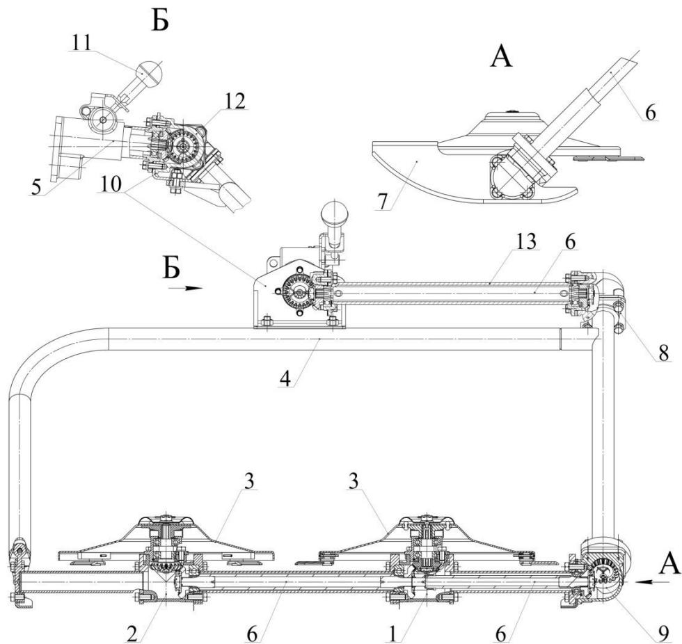
**Рисунок 1б – Косилка роторная навесная «Заря»
