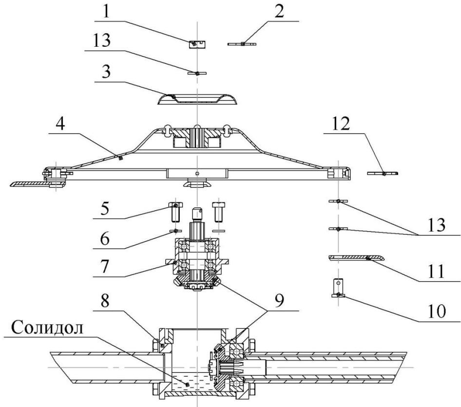
**Рисунок 2 – Режущий диск и его привод.**
